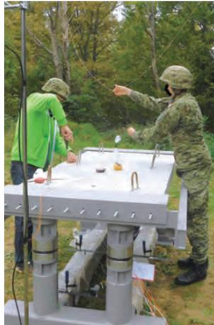
žiti stup mosta koji nije eksperimentalno ispitan. To je znatno sigurnije, jeftinije i brže nego eksperimentalno ispitivanje. Nakon ispitivanja tipovi oštećenja stupa i/ili oblici otkazivanja bit će katalogizirani, a u skladu s dobivenim podacima dat će se prijedlozi za moguća ojačanja stupova te buduće projektiranje. Eksperimentalni je program podijeljen u tri faze. Prva faza eksperimentalnog programa namijenjena je određivanju parametara eksplozije te
