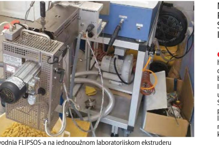
Proizvodnja FLIPSOS-a na jednopužnom laboratorijskom ekstruderu
