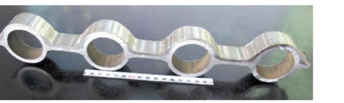
Navareni sloj Ni legure na membranski zid
