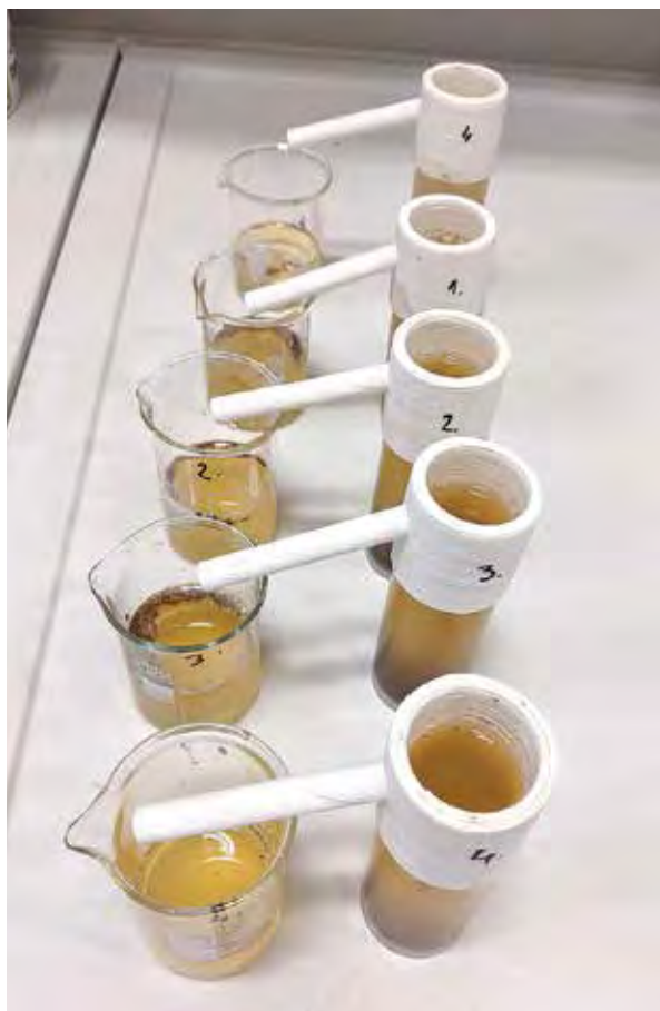
Izdvajanje mikroplastike iz sedimenta
