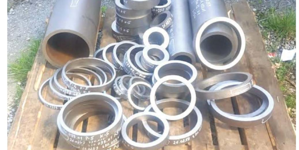
Ispitni uzorci predviđeni za mjerjenja zaostalih naprezanja
