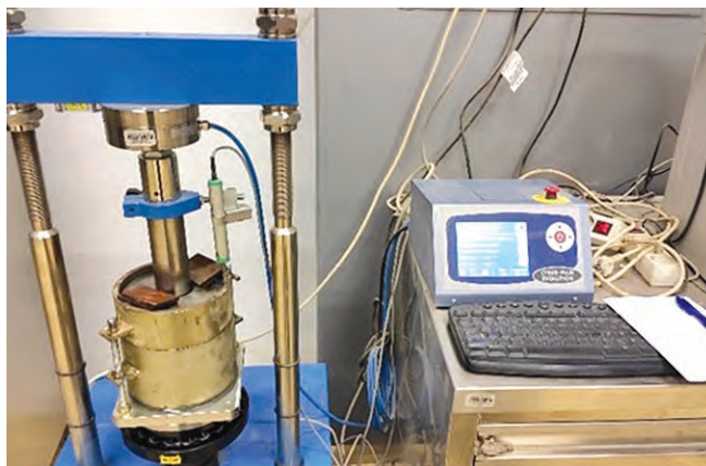
Ispitivanje indeksa nosivosti CBR na mješavinama pijeska i drvnog pepela
