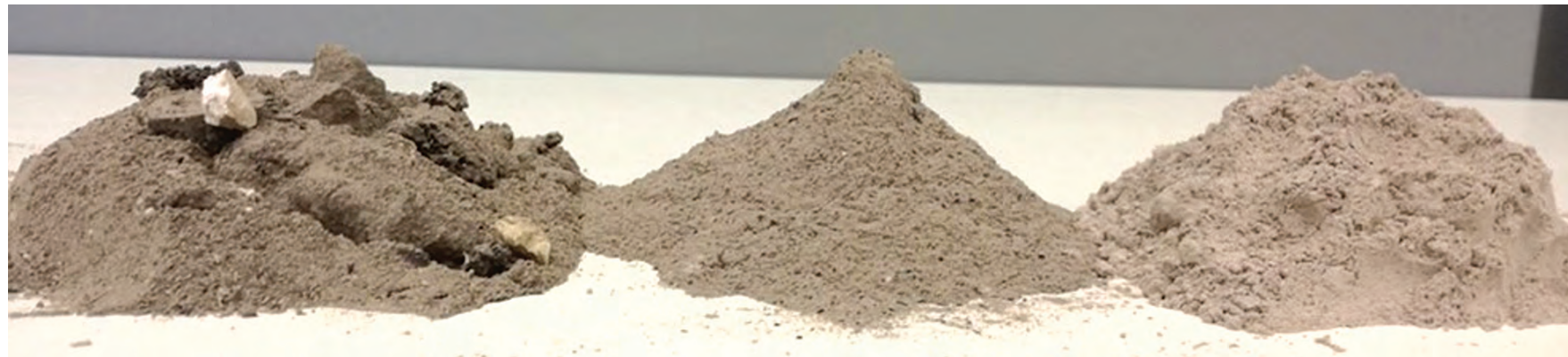
Frakcije drvnog pepela: peepo ložišta, ciklonski leteći pepeo, filterski leteći pepeo
