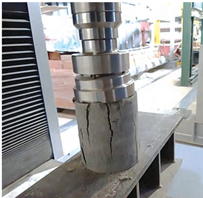
Ispitivanje tlačne čvrstoće na mješavinama pijeska, cementa i drvnog pepela
